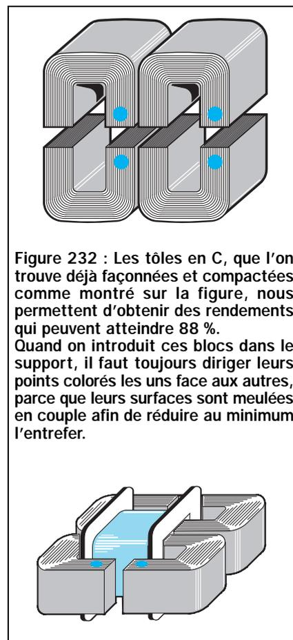
Figure 232 : Les tôles en C, que l'on trouve déjà façonnées et compactées comme montré sur la figure, nous permettent d'obtenir des rendements qui peuvent atteindre 88 %. Quand on introduit ces blocs dans le support, il faut toujours diriger leurs points colorés les uns face aux autres, parce que leurs surfaces sont meulées en couple afin de réduire au minimum l'entrefer.
