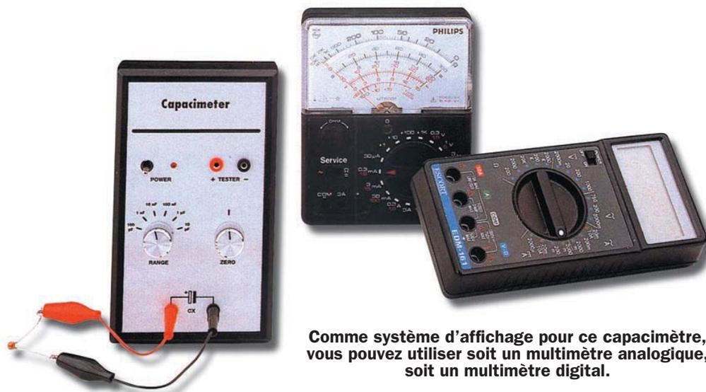
Comme système d'affichage pour ce capacimètre, vous pouvez utiliser soit un multimètre analogique, soit un multimètre digital.
