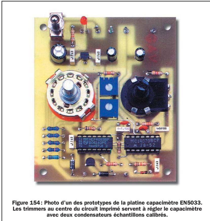
Figure 154 : Photo d'un des prototypes de la platine capacimètre EN5033. Les trimmers au centre du circuit imprimé servent à régler le capacimètre avec deux condensateurs échantillons calibrés.
