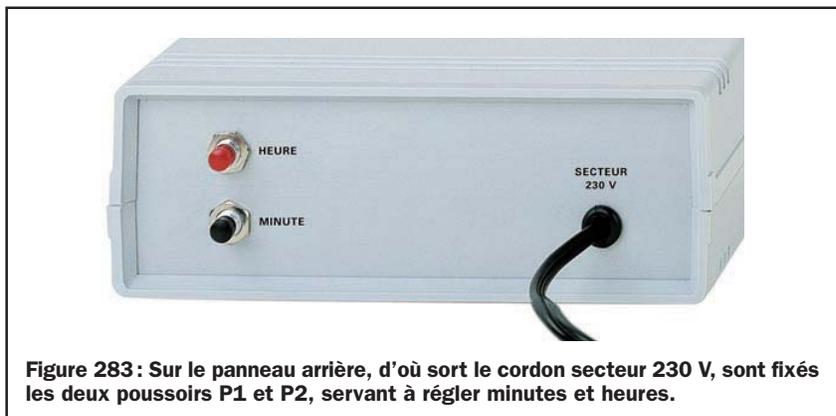
Figure 283: Sur le panneau arrière, d'où sort le cordon secteur 230 V, sont fixés les deux poussoirs P1 et P2, servant à régler minutes et heures.
