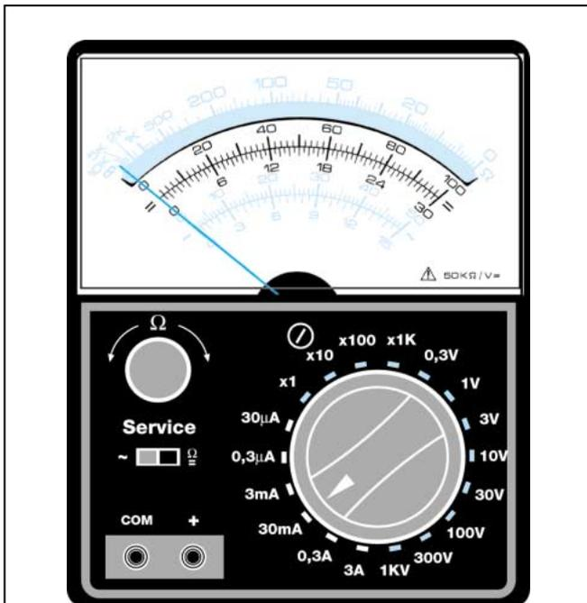
Figure 374 : Concernant la fonction ampèremètre CC, en tournant le bouton sur les échelles indiquées 30-0,3  $\mu$ A, 3-30 mA ou 0,3-3 A, la valeur sera lue sur l'échelle graduée de 0 à 30. Pour l'échelle 0,3 A, la valeur sera divisée par 100, tandis que pour l'échelle 3 A, elle sera divisée par 10.
