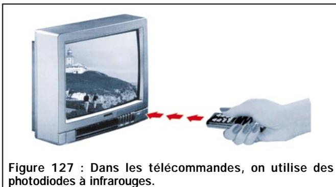
Figure 127 : Dans les télécommandes, on utilise des photodiodes à infrarouges.
