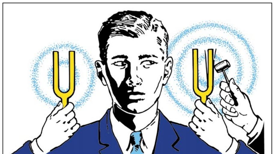
Figure 193 : En faisant vibrer un diapason avec un petit marteau, il émettra des ondes sonores qui parviendront à faire vibrer un autre diapason, pourvu qu'il soit proche et accordé sur la même fréquence.
