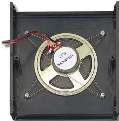
Figure 361 : Pour fixer le haut-parleur sur le couvercle du boîtier, vous devrez visser des vis autotaraudeuses dans les supports plastiques et, ensuite, enrouler sur celles-ci deux morceaux de fils de cuivre en les disposant en "X".
