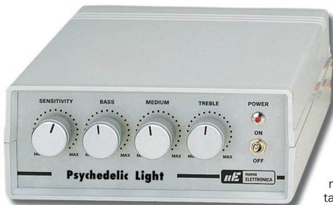
**Figure 560 :** Voici comment se présente, une fois terminé, le boîtier pour lumières psychédéliqués capable de piloter des ampoules de 12 volts.
